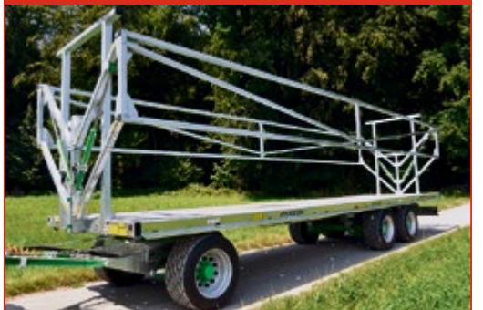
Joskin WAGO 24 t, Seitenschienen hydraulisch 24 t, ridelles hydrauliques
