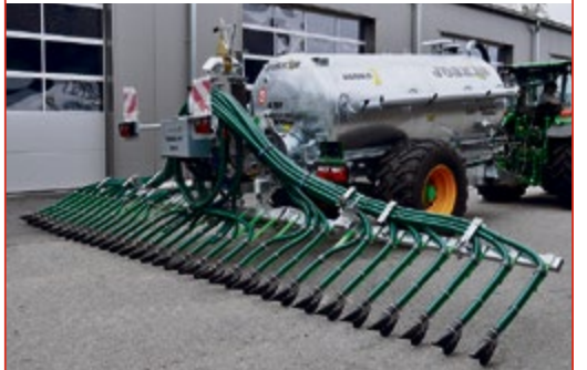
Joskin MODULO 7000 Schleppschuhverteiler 7.5 m Rampe à patin 7.5 m
