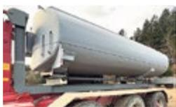
**Güllentank Abrollcontainer Alu 11 m³**, für Hakengerät, Steinfangmulde (Heck), hydr. angetriebene Drehkolbenpumpe ü. Steuerventil betätigt, Schauglas als Füllstandsanz. (Heck), 2 Luken auf Oberseite m. Laufsteg
