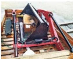
**Massey Ferguson 140C, chargeur frontal, d'expo, prévu pour MF 1740 / 1747, incl. consoles et pelle à matériaux légers**
