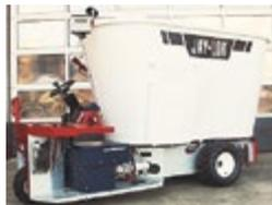
**Jaylor A5100 Vertikalmischer**, Volumen 2.6 m<sup>3</sup>, selbstfahrend, mit Schneidmessern, Allradantrieb, Waage, Benzinmotor 23 PS
