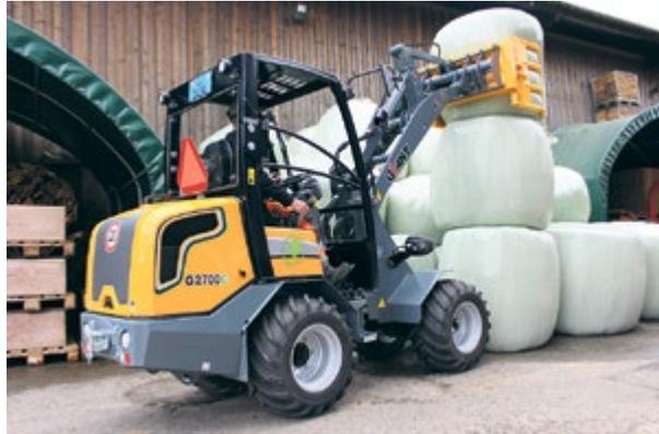
präzises Arbeiten zur Verfügung. Mit einer Fahrzeugbreite von 1'080 bis 1'420 mm und einem, ausstattungsabhängigen Transportgewicht von rund 2'500 kg findet der G2700E auch auf engstem Raum Platz und kann bequem mit dem 3.5-t-Anhänger transportiert werden. Vielfältige Ausstattungsoptionen, die Komfortkabine mit intuitiven Bedienelementen sowie umfangreiche Ausrüstungsmöglichkeiten für den landwirtschaftlichen Einsatz runden das Angebot ab.
