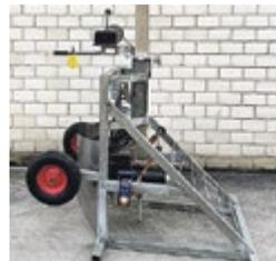
**Wälchli TMRW 125 Tauchmotorrührwerk**, 12,5 PS Elektromotor, neues Fahrwerk verzinkt
