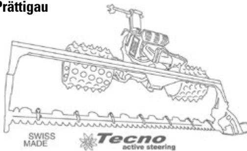
Kommst Du mit dem Tecno in eine Notsituation, kannst Du den Totmannschalter einfach loslassen. Die Bremsen blockieren und halten den Mäher sofort. Es ist kein Bremsen, Kuppeln oder Schalten notwendig. Du kannst Dich am Mäher festhalten, nicht umgekehrt!
