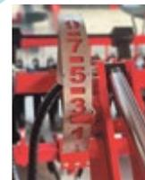
← hydraulische Einstellung der Arbeitstiefe mit Anzeige
