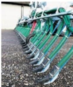
**Bomech Farmer Ausstell-Schleppschuhverteiler**, Arb.br. 15m, Stützräder re.+li., Schlauchset 6» zum Fass-Abgang, 3x DW für Ein-/Ausklappen–Heben/Senken–Verteilköpfe, 2x30 Abgänge 40mm Schlauch, Schleppschuhabst. nur 25cm, aktiver Druck auf alle Kufen 8–10kg
