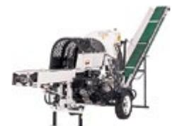
**Lumag SSA-500GPRO-S vollhydr. Sägespaltmaschine,** Benzinmotor, 420m³, Spaltlänge 50-55 cm, Spalt-Ø 10-50 cm, Spaltkraft 15t, Abförderband 3200x250x2200 cm, 4-6 m³ Holz/Stunde verarbeiten
