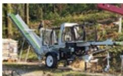
**Lumag Fräse-Spaltmaschine,** zum Bearbeiten Rundholz bis 0.5m Ø und bis 5.0m Länge, neuwertig
