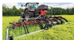
**Saphir Grünlandstriegel GS 603 mit pneum. Sägerat DrillStar 300E, Demo, Jg. 2021, zur mech. Unkrautbekämpfung und Belüftung der Grasnarbe, 12 bodenschonende Gleitkufen**
