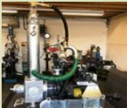
**DODA AFI 27, ZW-ZENTRIFUGALPUMPE neu**, verschleissfeste Widia-Wellendichtung, auf 3-Punkt-Bock montiert, 80-150 PS, 800-3000 l/min, 160 m³/h, Ansaug Kaiser 150, GW
