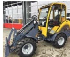
**Eurotrac W 12S Hoflader**, Motor Kubota, Aufnahme Euro 8, Kabine mit Heizung
