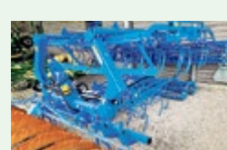
Lemken Korund 8/450 K Ausstell-Federzinkenlegge , hydr. klappbar, Maraton- zinken 30 x 12 x 400 mit Schar, 3 Arbeitsfelder à 1.5m, Arb.br. 4.5m Preis: auf Anfrage
