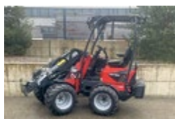
Norcar a7035 Einsteigermodell in die 1'500 kg Klasse mit Teleskoparm Hubhöhe 3,30 Meter 26 PS Perkins-Motor CHF 49'900.00
