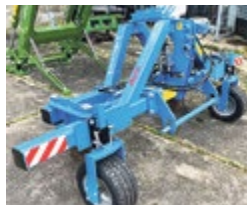
Schmotzer AV5 Ausstell-Verschieberahmen , feinfühliges Parallelversch. über Doppelrahmen, für Arb.br. bis 9 m, Seitenversch. 64 cm (+/- 32 cm), schneller Geräterwechsel durch Fangkupplungen, inkl. Kamerasystem HORUS Prix: Fr. 23'500.- Kontakt: Reto Maugweiler Telefon 076 463 51 15 www.agrar-landtechnik.ch
