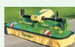
Krone EasyCut F 320 CV Ausstell-Frontmäherwerk , Arb.br. 3165 mm, integr. Aufbereiter mit V-Stahl- zinken, Messerschnell- verschluss, Überlastsiche- rung «SafeCut Inside» Preis: auf Anfrage
