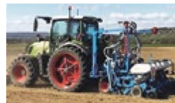
Treffler TS 1520/HN Ausstell-Präzisions-Zinkenstriegel , Arb.br. 15 m mit je 10 cm Überlappung, 6 Stützräder, hydr. zentr. Zinkendruckverstellung, el.-hydr. Steuerung (Albatrosstellung) der Striegelfelder Prix: Fr. 49'000.- Kontakt: Reto Maugweiler Telefon 076 463 51 15 www.agrar-landtechnik.ch
