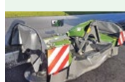
Fendt Cutter 3140 FPV Demo-Front-Trommel- mähwerk , Jg. 2021, 875 kg, Arb.br. 3.06m, Transportbr. 3m, Anbau mit Pendelbock +/- 5°, klappbare Aussen- schütze, 4 Mähtrommeln mit je 3 Klingen Preis: Fr. 11'700.-
