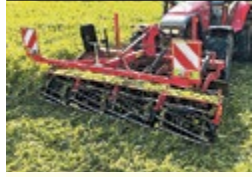
Speedmax 300, X-Schnitt 2-reihige Messerwalze Arbeitsbreite 3 m
