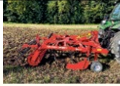
Ökogrubber GSÖ-3 , Arbeitsbreite 3 m, mit Nachläufer RPV480
