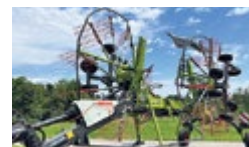
Claas Liner 1700 Twin Ausstell-2-Kreisel- Schwader, Jg. 2024, Seiten- o. 2-Schwadablage, Arb.br. 6,7–7,85 m, Schwadbr. 0,90– 1,3 m, 2 Kreiselkörper à 12 Zinkenträgern, 4 Dop- pelfederzinken pro Träger, Kreisel-Ø 3,2 m, Zinken-Ø 9,5 mm, MFK braun Preis: auf Anfrage Telefon 071 385 12 64 www.kellerlandtechnik.ch
