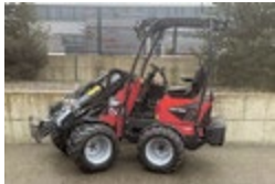
Norcar a7045 Einsteigermodell in die 1'500 kg Klasse mit Teleskoparm Hubhöhe 3,30 Meter 26 PS Perkins-Motor CHF 49'900.00
