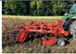
Ökogrubber GSÖ-3, Arbeitsbreite 3 m, mit Nachläufer RPV480
