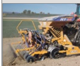
JET-M DIE SÄKOMBINATION kompakt und pneumatisch mit vielen Alpego Kreiseleggen kombinierbar, mit elektronischer Saat-Steuerung
