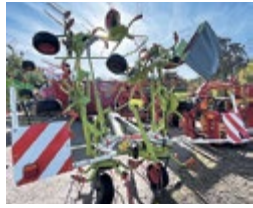
Claas Volto 77 Kreiselheuer, Arb.br. 7.7 m, Anbau Kat. 2, 8 Kreisel, 5 Zinken pro Kreiselglocke, Kreisel-Ø 1.3 m, Tastrad Preis: Fr. 11'750.- Telefon 071 385 12 64 www.kellerlandtechnik.ch
