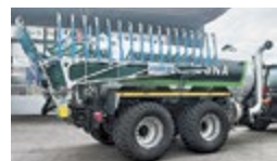
Bonsegna 11500 Ltr. Tandem-Güllefass, Vakuum-Pumpe 13500 l/min, Saugarm rechts, Turbofilter, Bereifung 710/50 R26.5 BKT A 10 FORI, Bomech Schleppschuhverteiler Speedy One 10.50m Preis: auf Anfrage Telefon 041 980 62 43
