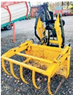
Big-Lift M 3-Punkt-Lift 322 kg, 2.11 m HH ohne Hydraulikhub, ca. 1200 kg HK auf Palettengabel, hydr. Kippeinrichtung, Parallelführung, Aufnahme Kat. 1, inkl. Krokodilzange 1.2 m Preis: Fr. 5'300.– Telefon 041 484 10 01 www.zihlmann-landmaschinen.ch
