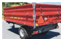
Strautmann SEK 702 1-Achs Dreiseitenkipper , Vol. 8 m³, GG 7 t, Bereifung 19.0/45-17, Aufsätze 2 x 500 mm, Auflaufbremse, Bordwandentlastungsfe- dern, Lagermaschine Preis: Fr. 14'200.– inkl. MwSt.
