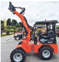
Ostler K2ST neu, Jg. 2025, 25 PS, HK 1.4 t, HH 3.06 m, extrem standsicher dank telesko- pierbarer VA & pendelnder HA, Euro 8 Aufnahme Preis: Fr. 38'500.- Telefon 079 752 77 81 www.mehrlandtechnik.ch
