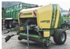
Krone Fortima F 1250 MC de démonstration, année 2022, chambre fixe, Ø de balles 1.25 m, ISOBUS Terminal DS 500, rotor d'alimenta- tion 17 couteaux, attelage en haut D40, graissage des chaînes autom., expertise 40 km/h Prix: Fr. 50'000.– Contact: Jérôme Kolly Téléphone 079 749 30 61 www.agrar-landtechnik.ch
