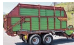
Strautmann Ambion 290 , Vol. nach DIN 28 m³, 47.6 m³ mittlere Pressung, Schwingerwagen mit 6 Messern, Tandemachse Bereifung 520/50-17, Ladeautomatik, Bremse DL mit ALB, MFK 40 km/h, Pick-up FLEX-LOAD Jetzt interessante Vorsaisonrabatte!
